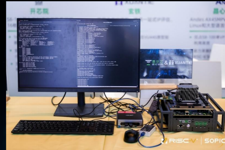
玄铁 R908在S7-19P逻辑系统展示实时运行效果
